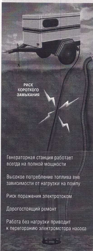
Электрический погружной насос с генераторной станцией
